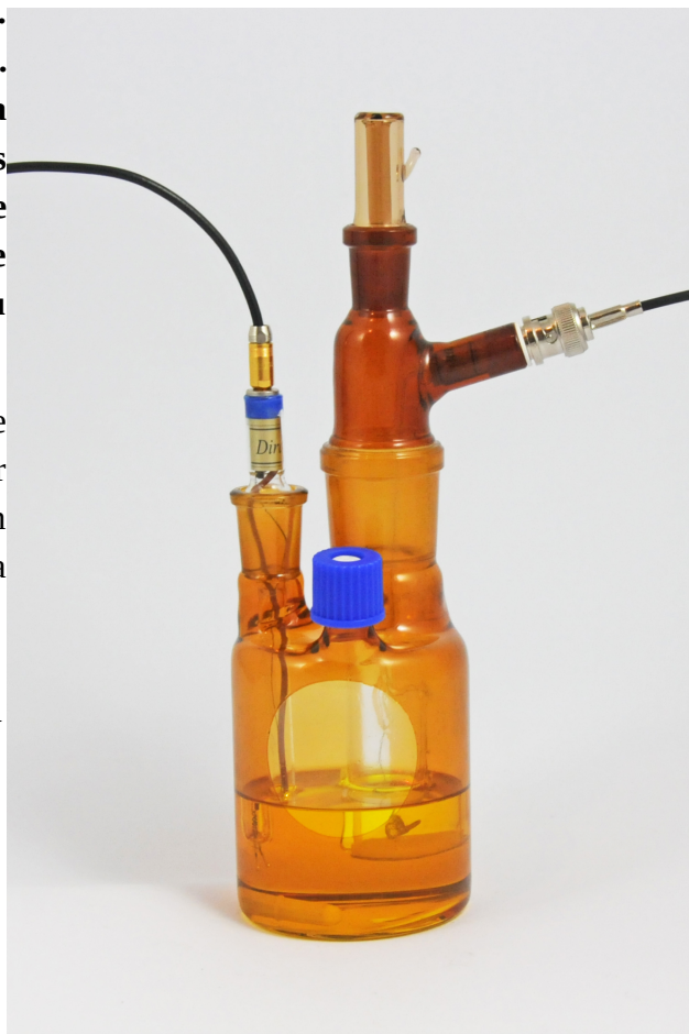
Obr 6: Titrační nádobka připravená k měření
